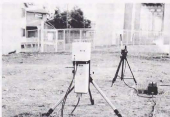
図 5-3-4. レーザードップラ速度計設置状況
