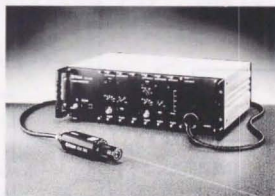
図 3-4-1. レーザードップラ速度計
