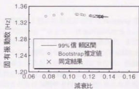
図 2-3-15. 固有振動数と減衰比の 99%信頼区間 (フィルター処理後)
