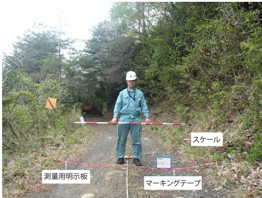
図1 路面侵食量計測用写真の例
