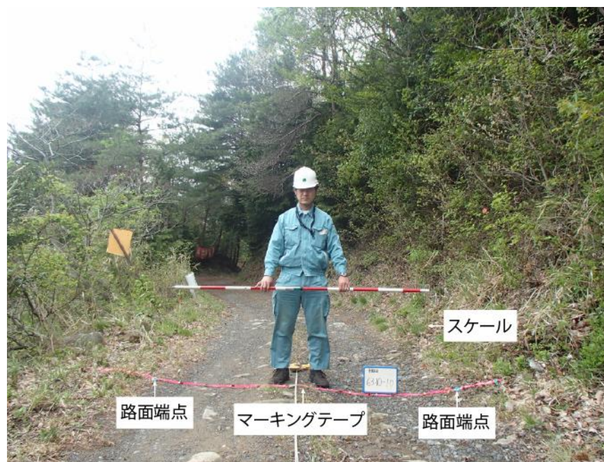
図 4.2 路面侵食量計測用写真の例
