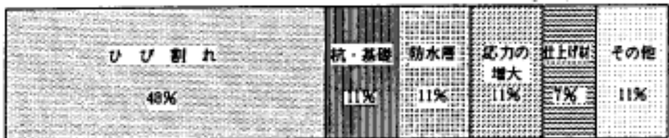
鉄筋コンクリート造（SRC 造を含む）で想定した不具合
