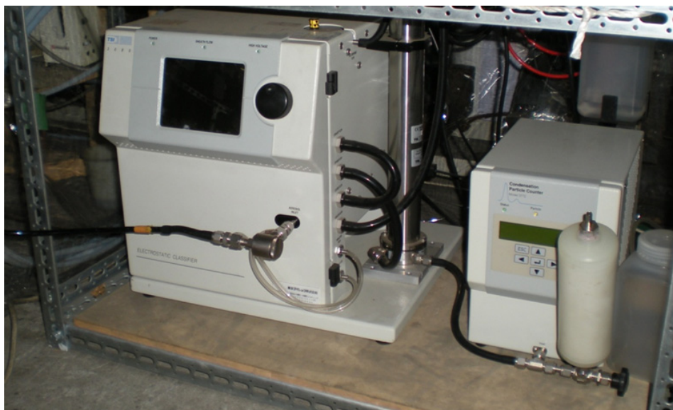
図 3-18 SMPS の外観 (Model 13080 (左) および CPC Model 13772 (右))
