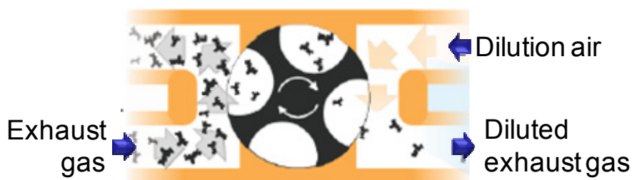
図 3-9 ロータリーディスク型希釈器の概要図(希釈ブロック部) 3-2)
