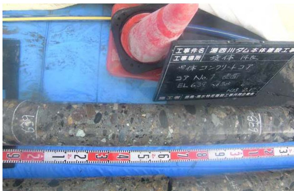
写真－4. 4. 30 採取コアの全景（湯西川ダム）
