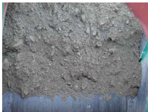
写真－4. 4. 25 模擬 RCD 用コンクリート
