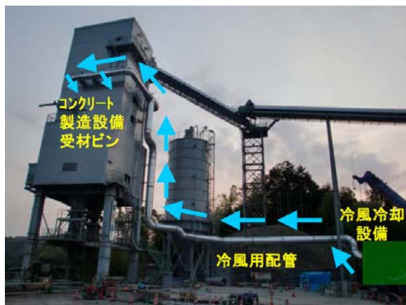
写真-2.10.5 冷風設備による粗骨材冷却状況
