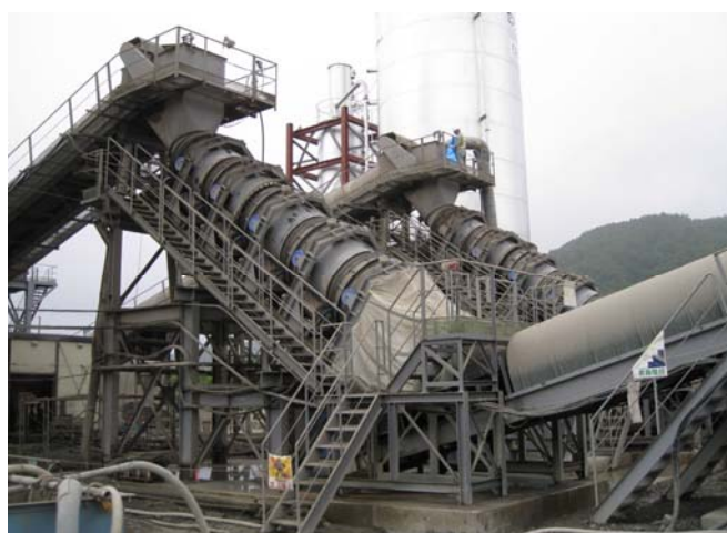
写真－2. 12. 3 当別ダムで使⽤した \phi 1, 200\text{mmSP} ミキサ（2009 年）
