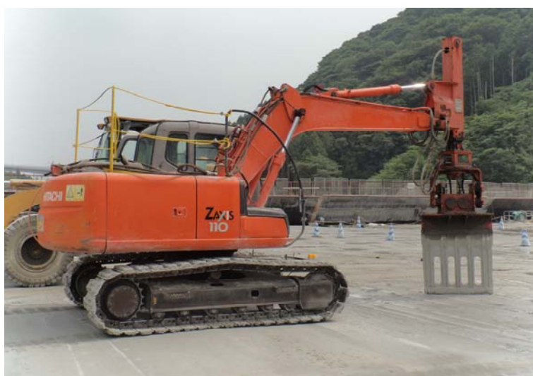
写真－3.3.5 振動目地切機（五ヶ山ダム）
