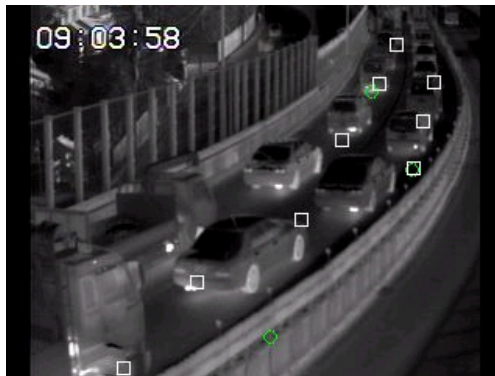
図 4-4-4 AHS 画像処理センサの処理画面（赤外画像処理センサの例）
