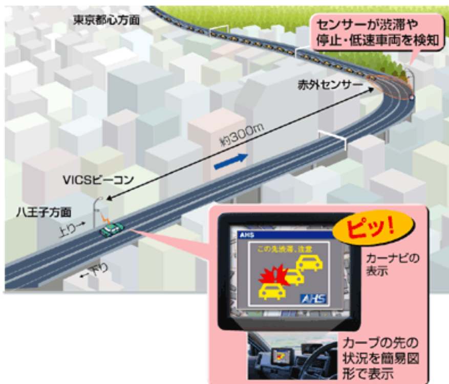
図 4-4-1 参宮橋カーブ前方障害物情報提供サービス
