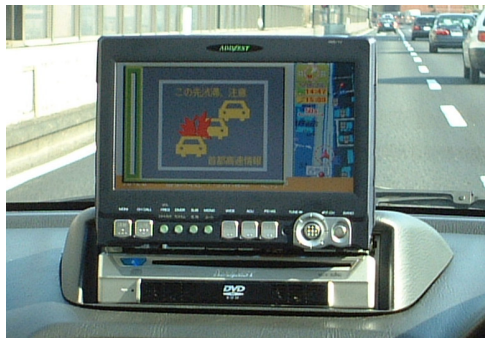
図 4-4-3 3メディア VICS 対応カーナビに、簡易図形で情報提供される様子
