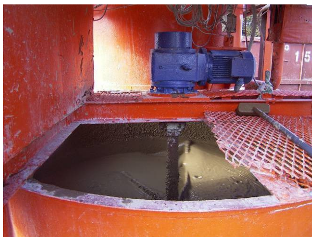
写真 2.2 プラント（左）と流動化処理（建設発生土と固化材の混合）の様子（右）
