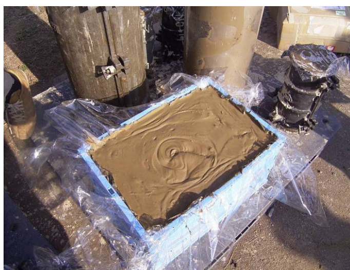
写真 2.3 コンテナに充填された直後の流動化処理土
