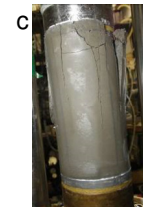
写真 5.4 試験終了後の各供試体の破壊状況（高強度セメント改良粘土）
