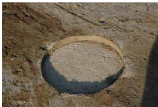
図 1.45 平板載荷試験後の流動化处理土の変形状況（出典 岩淵ら，2006）
