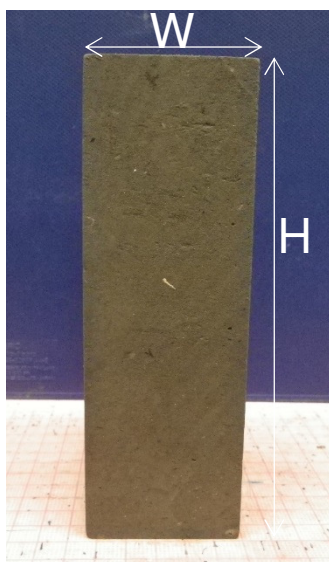
写真 2.7 堆積軟岩供試体の一例
