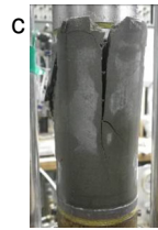
写真 5.4 試験終了後の各供試体の破壊状況（高強度セメント改良粘土）
