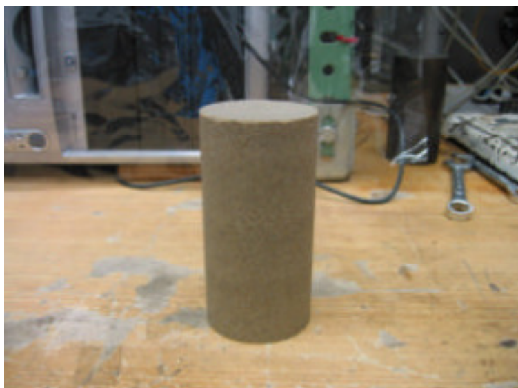
写真 2.6 セメント改良砂供試体の一例
