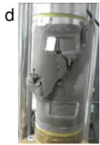
写真 5.4 試験終了後の各供試体の破壊状況（高強度セメント改良粘土）
