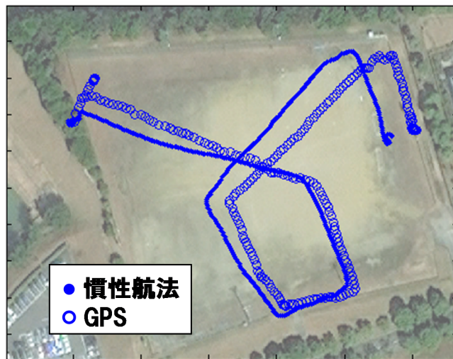
図 7-7: スマートフォンによる慣性航法の例
