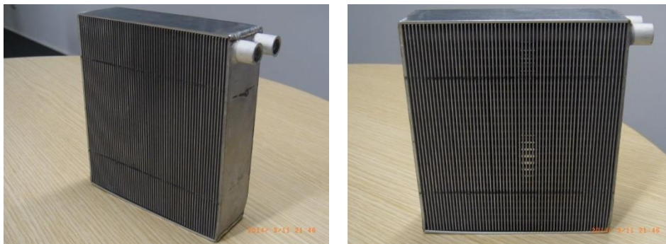
図 4.6 デスクトップパソコン用の熱回収装置 (ドロンカップ熱交換器)
