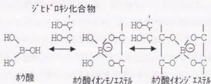
図 1-2 ホウ酸とジヒドロキシ化合物との反応
