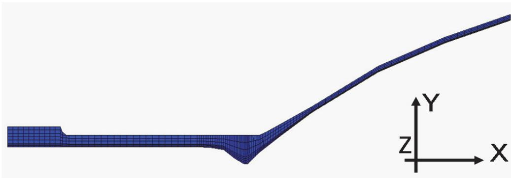
図 5-11 小推力2液式スラスタ（推力22N）[8]の有限要素解析モデル
