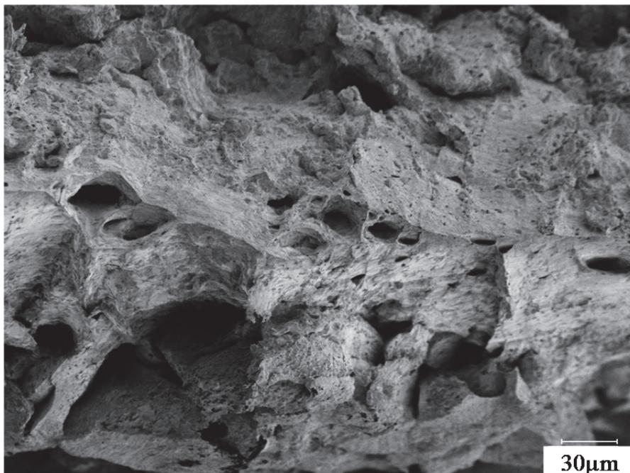
図 4-18 静的引張試験後の試験片の破断面写真
