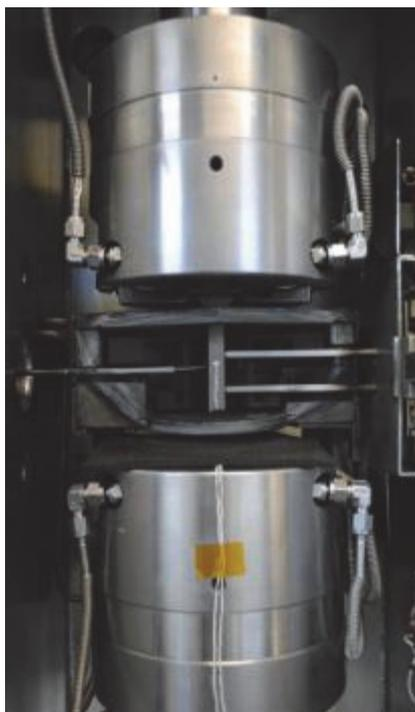
図 4-2 静的引張試験の試験セットアップ
