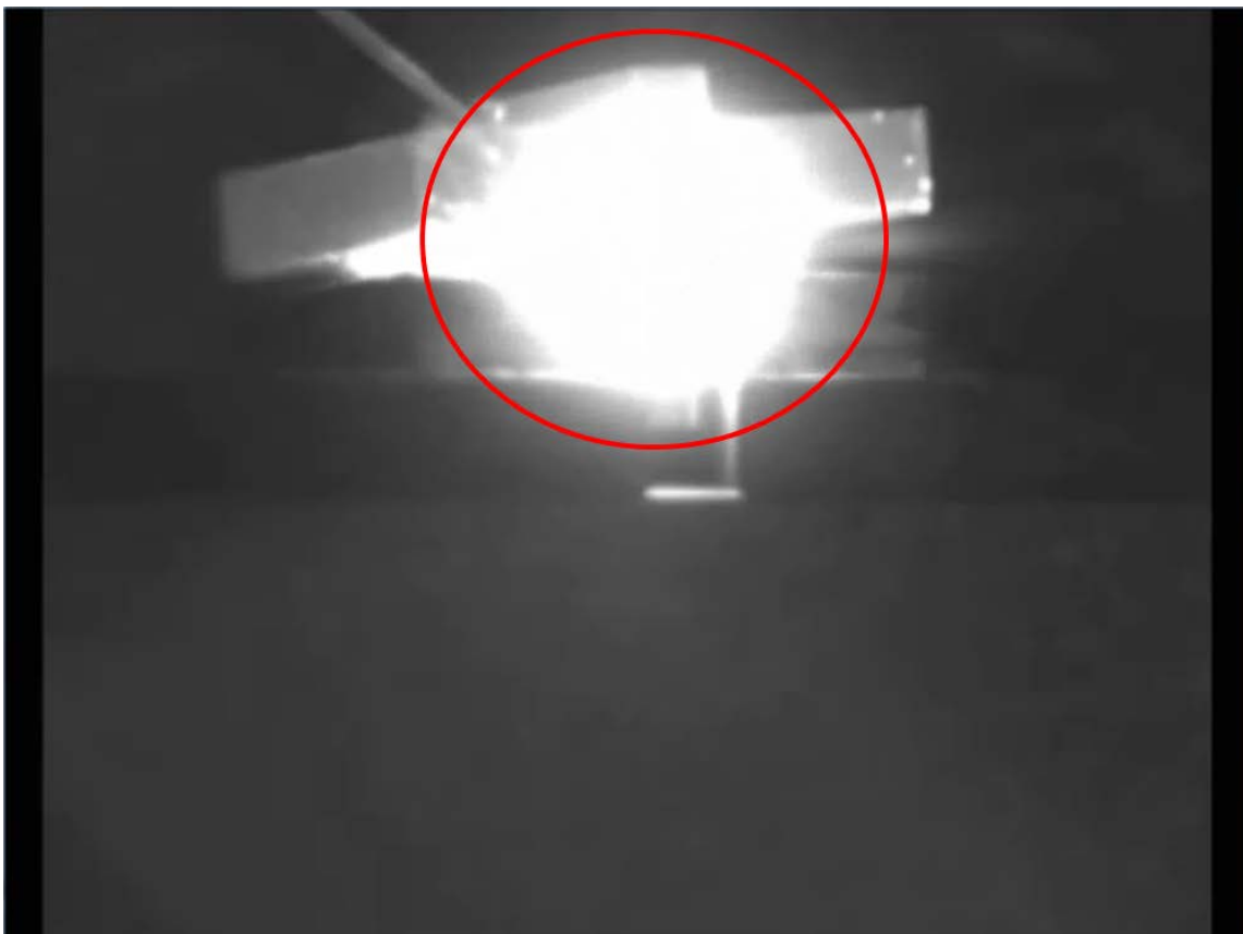
Fig. 4-25 Si レーザー#3 Lot 3 DPP 援用アニールの様子 赤外線カメラ像 レーザー端部からの発光
