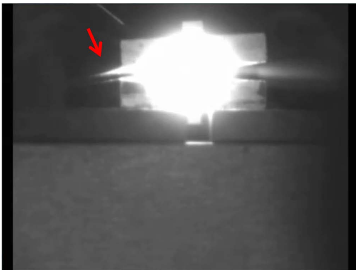
Fig. 4-27 Si レーザー#3 Lot 3 DPP 援用アニール後、レーザー端部からの発光確認 赤外線カメラ像 赤矢印部のマウント温度低いこと確認
