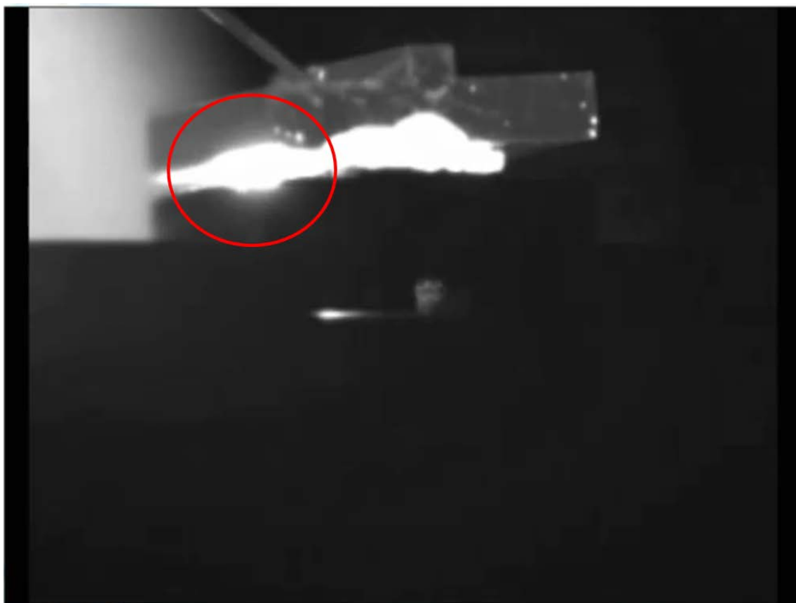
Fig. 4-24 Si レーザー#3 Lot 3 DPP 援用アニールの様子 赤外線カメラ像 赤丸部からの発光
