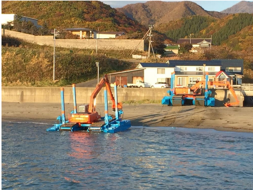
図 3-2. コンブ漁場造成のため雑海藻類の除去に使用されている大型重機
