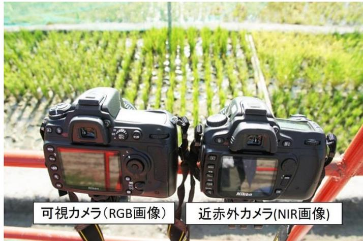
図 3-3 マルチスペクトル画像計測システム
