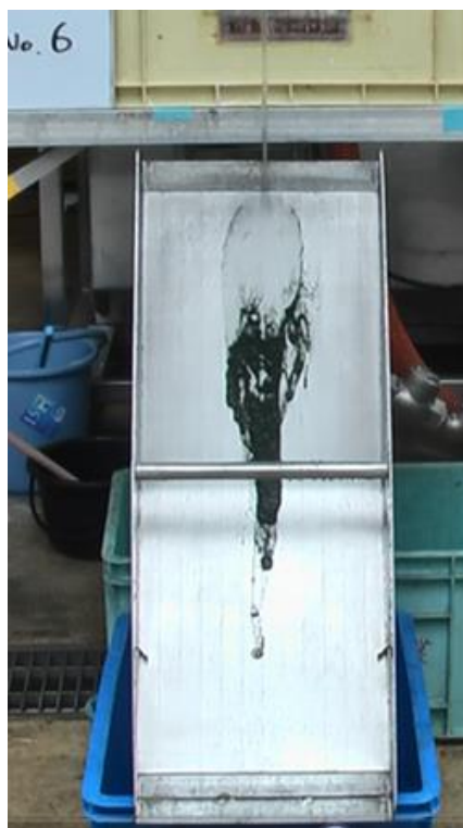
図 5-4. ウェッジワイヤースクリーン素子を用いた重力による傾斜型固液分離装置を用いた収穫実験の様子.
