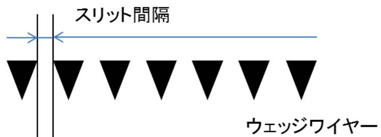
図 5-3. 断面が 3 角形のウェッジワイヤーにより構成されたスクリーン素子の断面拡大図.
