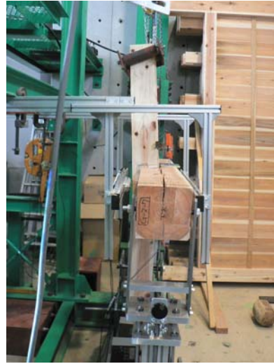
(6) 変形角+1/7rad 柱の変形
