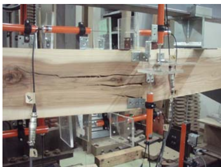
(3) D2-3-2 へそ上部の割裂
