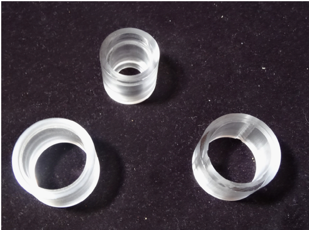
Fig5-3-39 3次モデルにおける動圧軸・軸受 上段：動圧軸（真円） 下段左：ジャーナル軸受（真円） 下段右：3円弧動圧軸受
