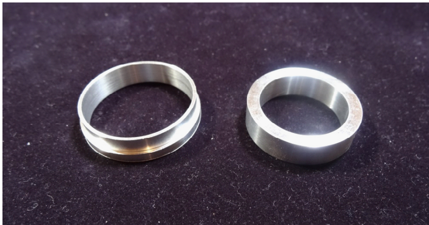
Fig5-2-17 シーケンシャルフロー型遠心ポンプの二次モデルにおける ジュラコン製動圧軸受
