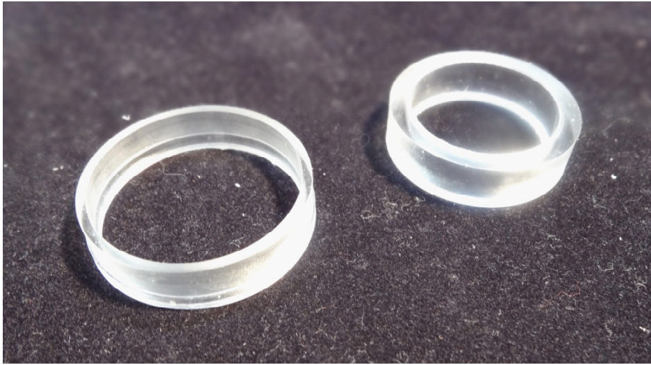
Fig5-2-16 シーケンシャルフロー型遠心ポンプの二次モデルにおける アクリル樹脂製動圧軸受
