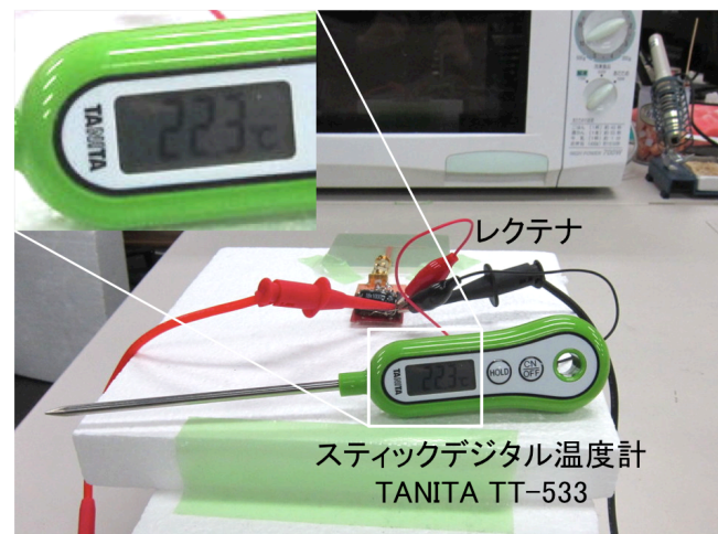
図 4.14: デジタル温度計の動作実験
