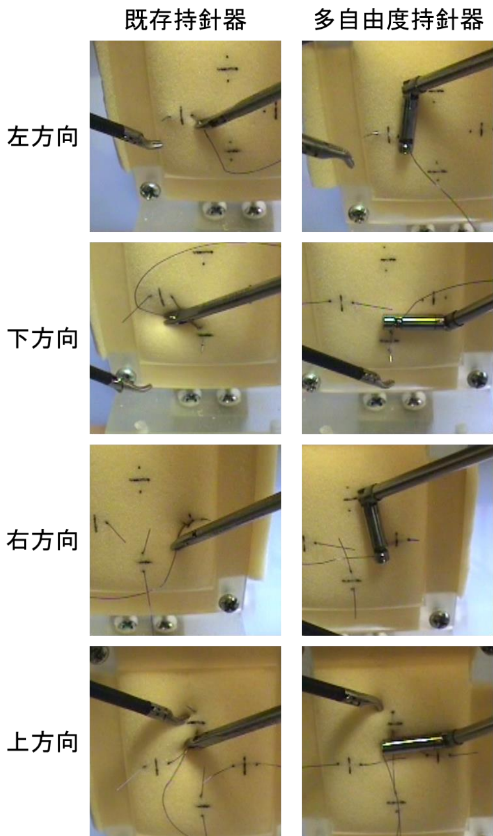
図7 既存持針器と多自由度持針器の各方向への運針の様子
