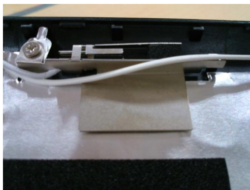
図 22： 本体内蔵の逆 F 型板金アンテナ
