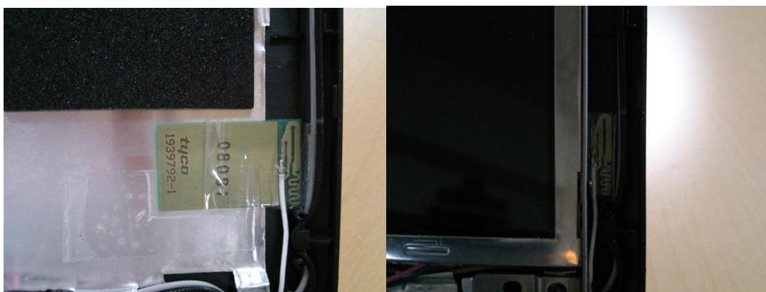
図 23： 追加した逆F型フィルムアンテナ
