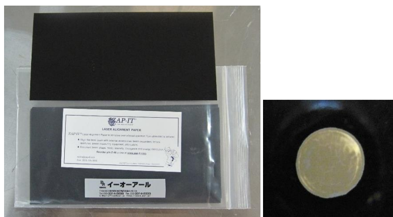
図 2-5 バーンペーパー (左) とバーンペーパーに焼かれたビームプロファイルの例 (直径 1 cm のトップハットビーム) (右)
