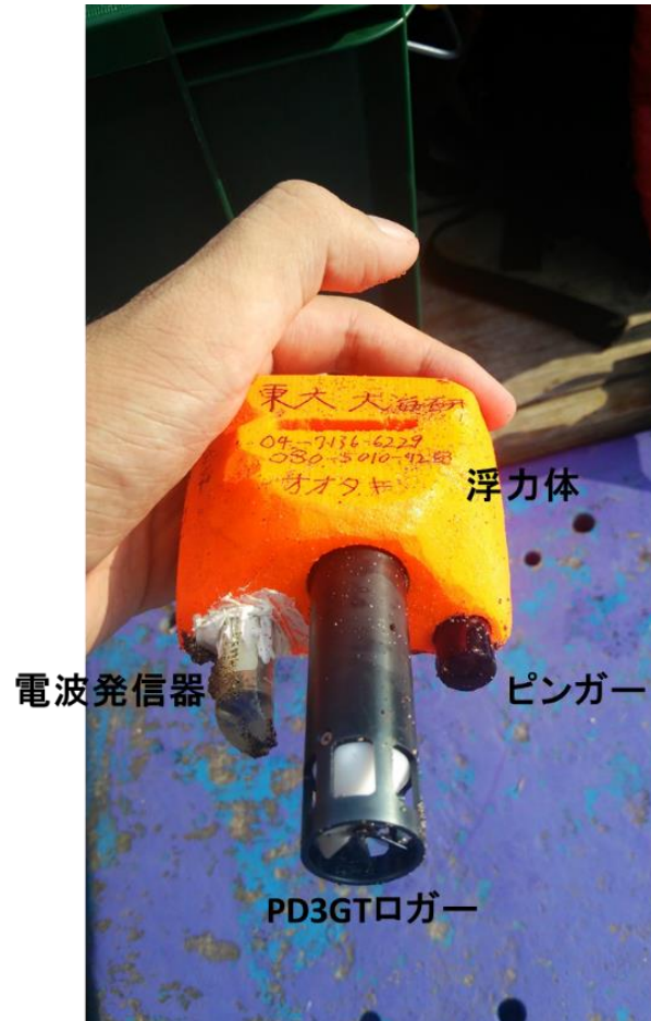
図 3-24. 左図は、PD3GT ロガー，超音波信号発信器(ピンガー)，電波発信器，浮力体を一体化した計測器．2013 年に使用．右図は，3MPD3GT ロガー，超音波信号発信器(ピンガー)，電波発信器，浮力体に一体化した計測器をアカエイ頭背部に取り付けた様子． 2014 年に使用．
