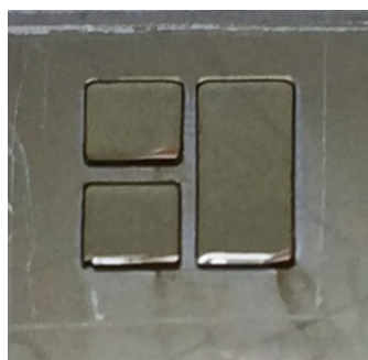
Fig. 3-4 作製した SU-8 鑄型. 左側の 2 つの小培養区画と, 右側の大培養区画が見られる.
