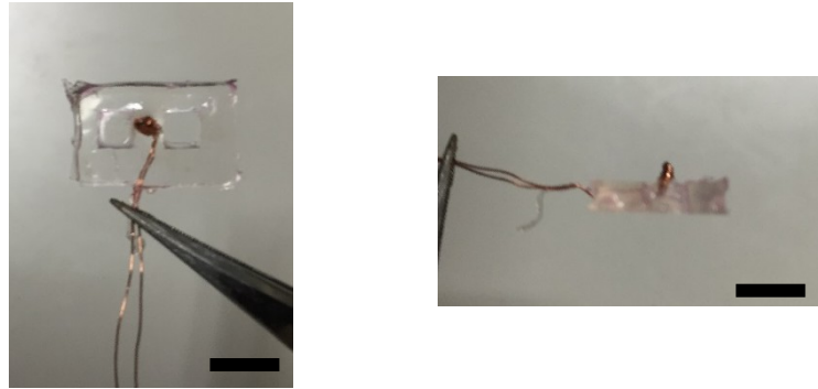
Fig. 4-4 微小コイルを埋め込んだ培養チャンバ. Scale bar, 5 mm.
