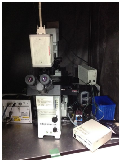
図 2-10 計測装置の概観と光学系の模式図．水銀灯の照射光の波長を，励起フィルタにより励起光の帯域のみに制限する．ダイクロイックミラーは，励起光は反射するが，蛍光は透過する．吸収フィルタにより，蛍光の波長のみを透過させる．
