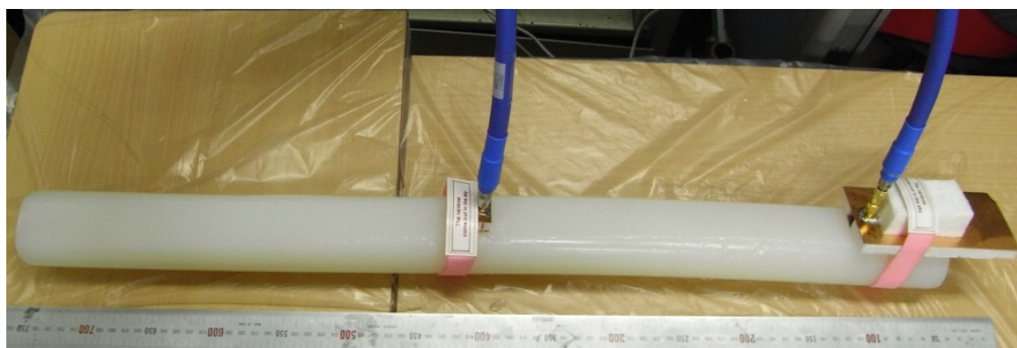
図 3.36 ネットワークアナライザを用いた人体通信の測定風景
