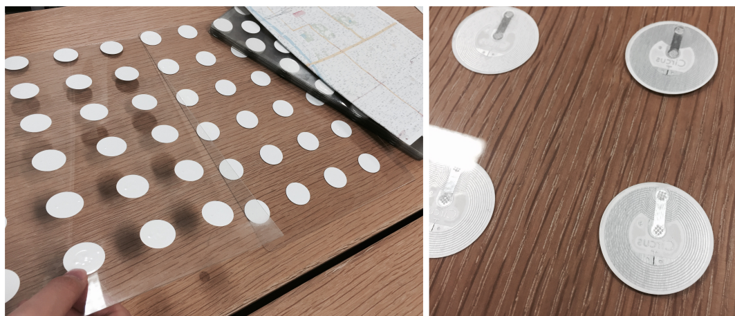
図 14 紙地図とスマートフォンとの連動を実現するための NFC シート
