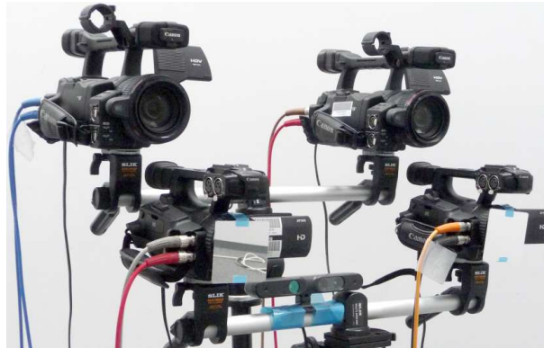
図 3.6 赤外線カラー分離型カメラアレー
