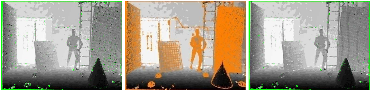
(a) 赤外線 Cost のみ (b) カーネルサイズが閾値以下の領域 (c) 赤外線 Cost とカラー Cost
