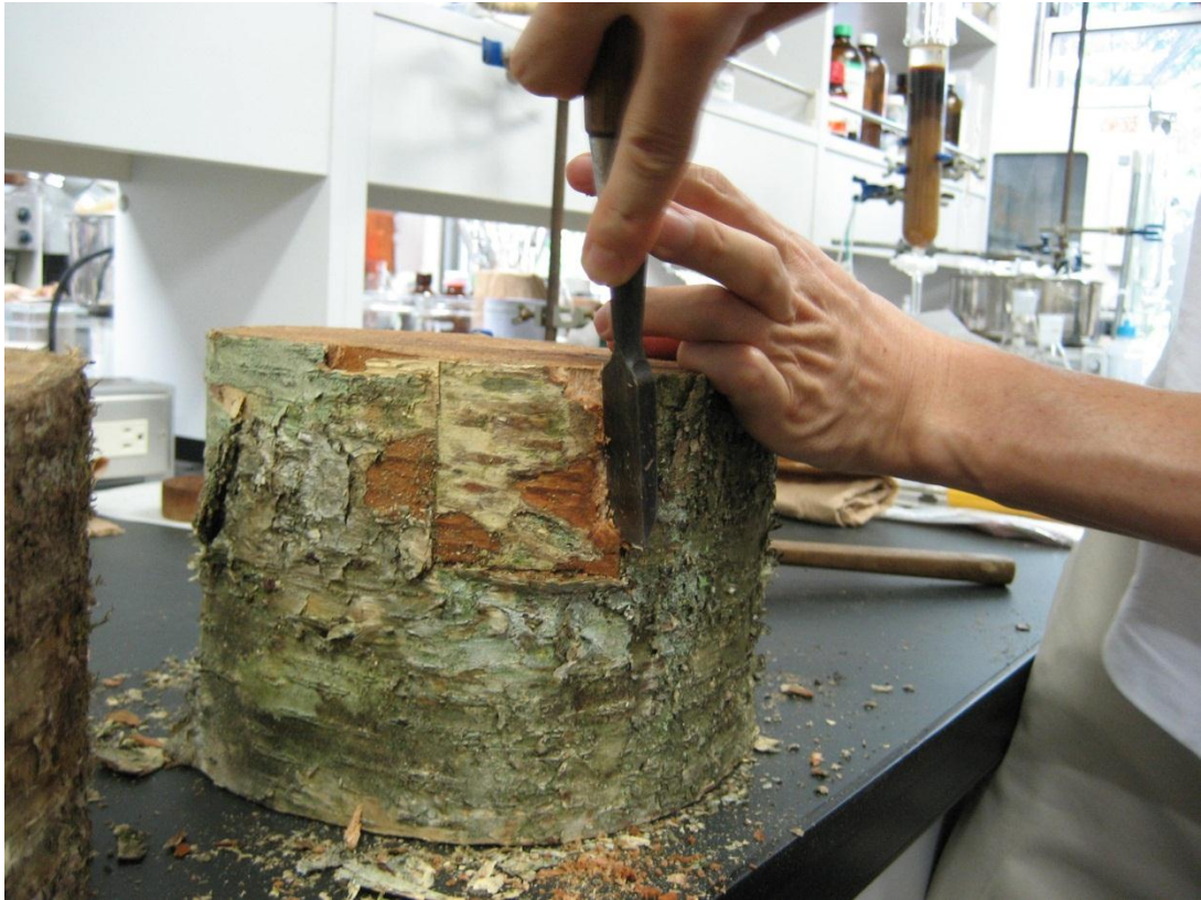
図 4.1 2008 年 5 月 2 日伐採・解体ウダイカンバ丸太からのサンプル採取(この例では、きれいに外皮が剥けない。)
