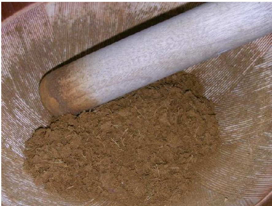
図 5.6 120 時間沸騰した水で煮続けた後、搗粉木で摩り下ろしたスギ針葉
