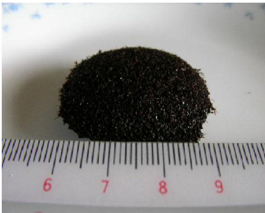
図 5.7 前図のものを再度 120 時間煮続し、4%水酸化ナトリウム水溶液に 96 時間浸漬し、水-アセトン-水で洗浄したもの（黒褐色を呈している。）
