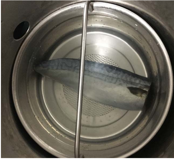
図-15A 噴流式超音波洗浄機(28 kHz)を用いた冷凍塩サバの洗浄
