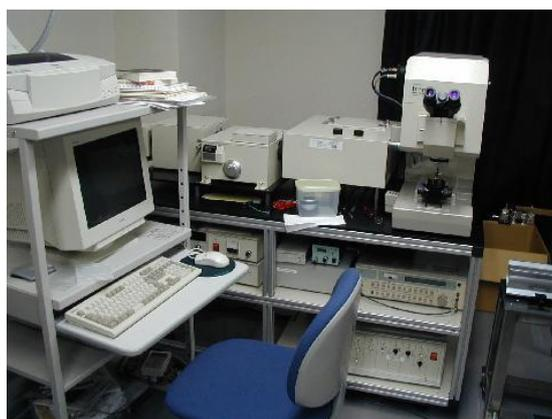
図 2.1 顕微可視分光測定システム
