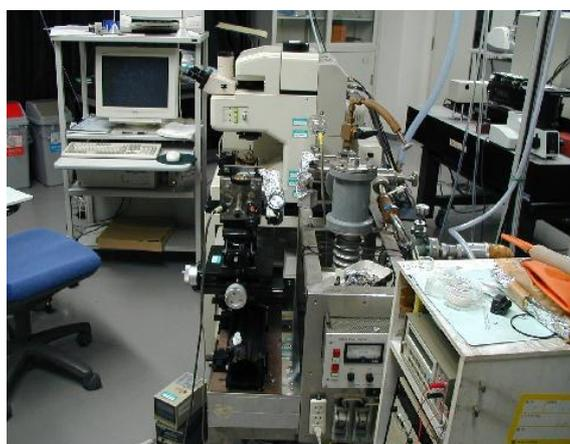
図 2.2 顕微赤外分光測定システム
