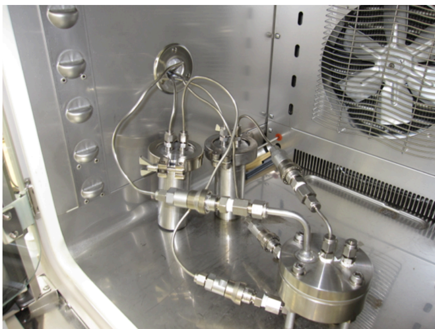
図 2.4 ガス分離実験用のセルとオープン
