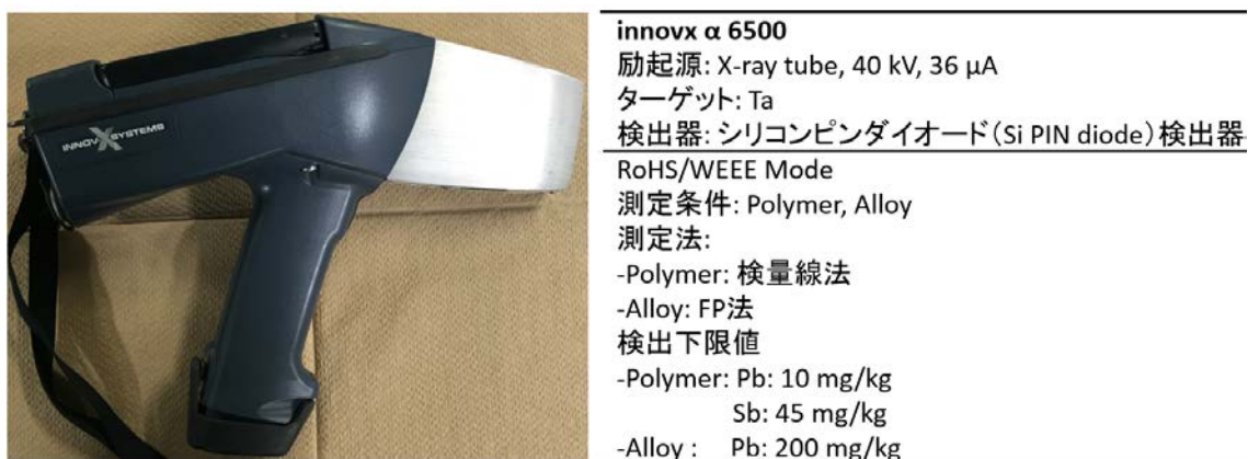
図 3. 可搬型 XRF (innovx α 6500) の概要
