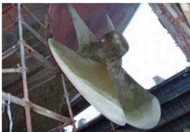
図 1-4 スクリュープロペラへの海洋生物付着例[5]
