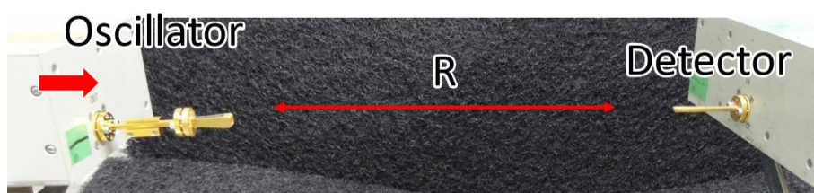
図 25 較正試験に使用した系
