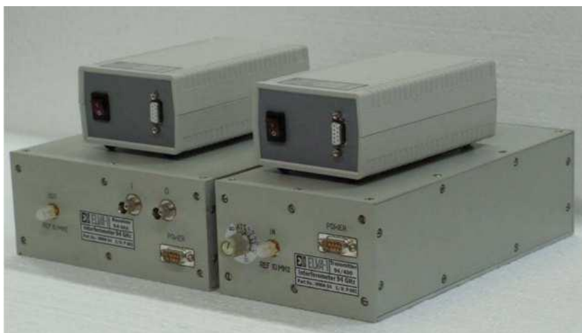
図 23 使用した発振器とヘテロダイン検波器
