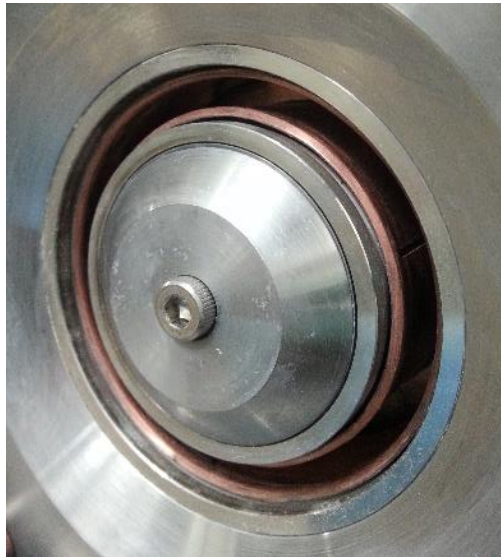
図 12 推進機前面の拡大図，銅製部品がホローアノード
