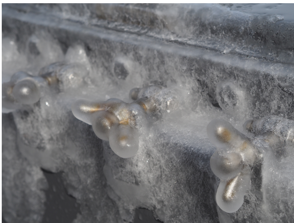
Fig.1.2 砕氷艦「しらせ」に付着した氷の様子
