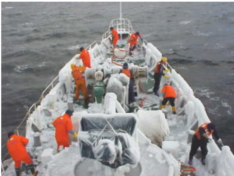
Fig.1.4 砕氷巡視船「そうや」で発生したより大規模な船体着氷の様子[7]
