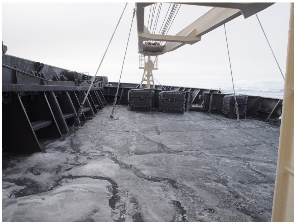
Fig.1.1 砕氷艦「しらせ」において発生した着氷の様子、艦首側
