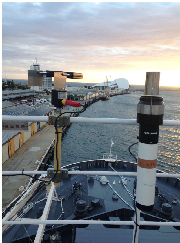
Fig.3.3.3 雨量計と SPC の設置の様子
