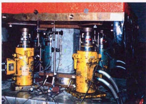
写真3.2 加力装置（試験体CPS）
