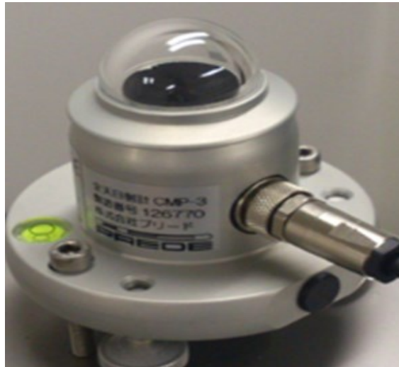
Fig. 3.3 日射量観測装置 (Kipp&Zonen 社, CMP3) (出典) [49]より抜粋
