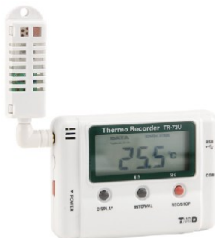
Fig. 3.2 気温， 相対湿度， 大気圧観測機器（T&D 社, TR-73U） （出典） [49]より抜粋
