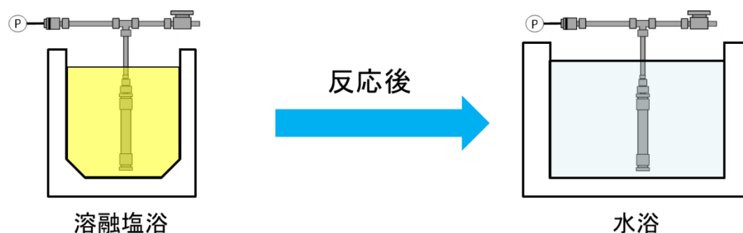
図 2-5：回分式ガス化実験における実験手順の概略図
