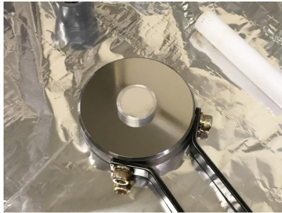
図 3.9 XRF 用の薄膜試料製作前
