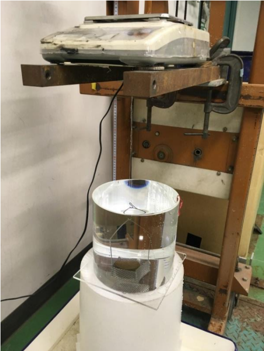
図 3.1 水中重量を測定する様子
