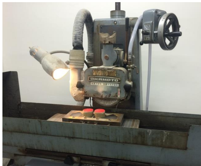
図 2.8 平面研削機
