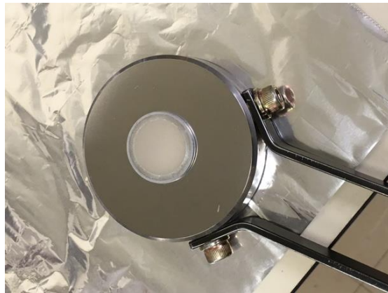
図 3.10 XRF 用の薄膜試料製作後（この写真ではアルミ製のリングを使用している）
