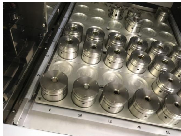
図 3.13 XRF 装置へのホルダー設置の様子
