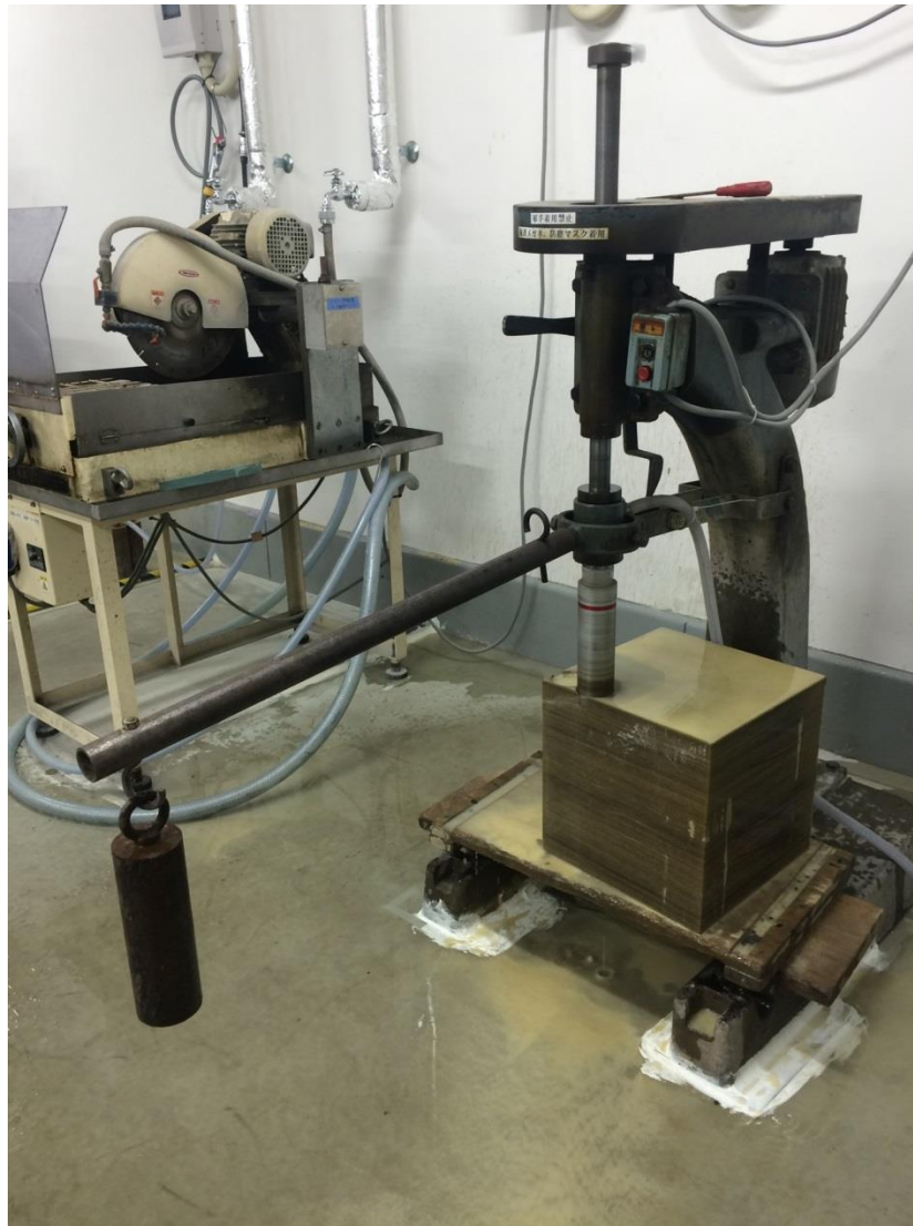
図 2.6 コアリングマシン（諫早砂岩のブロックをコア抜き中の様子）
