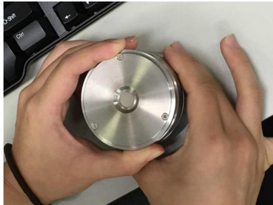
図 3.12 XRF 薄膜試料のホルダー作成
