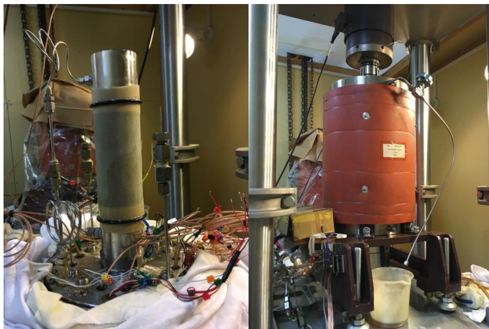
図 3.22 ゴムスリーブに入れた試料の装置への設置途中の状態（左）と三軸試験機設置後の状態(右)
