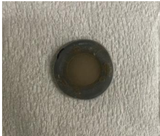
図 3.11 実際に試験に使用した女川層の XRF 薄膜試料
