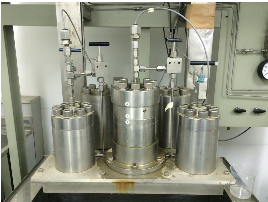
図 4.2 トランジェントパルス試験機
