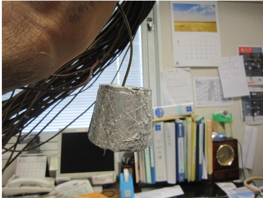
Figure2.4：温度センサーに取り付けた放射除け
