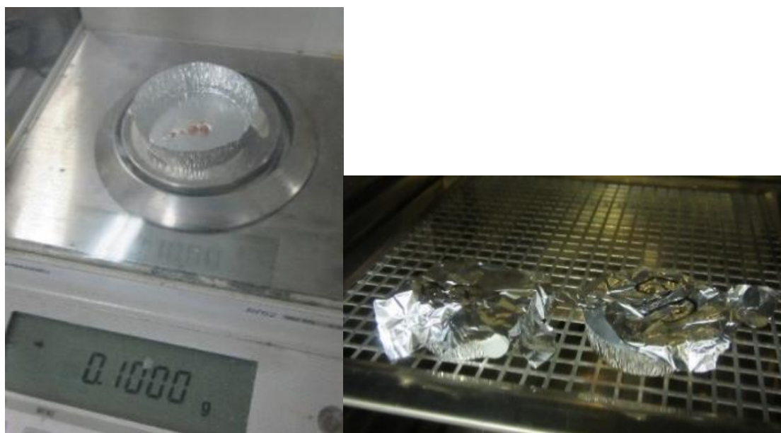
図 3-14 本研究で代用したアルミ容器と測定の様子
