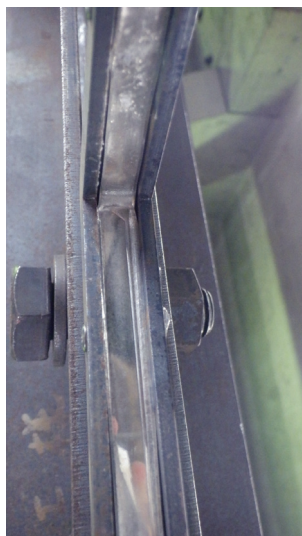
図 19: 錫圧縮状況 (フランジ幅 14mm)
