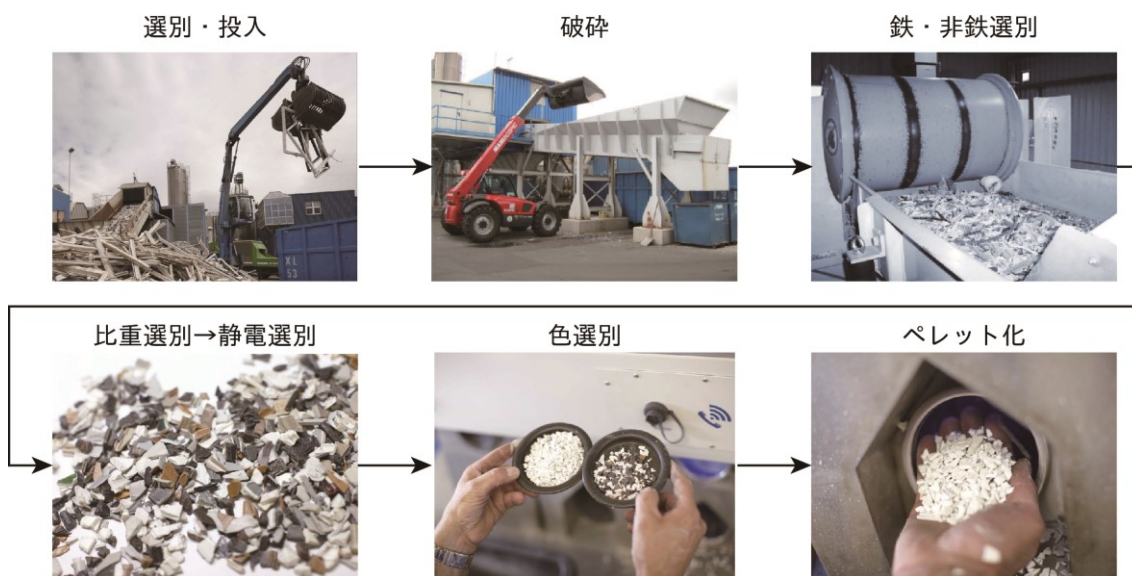
図 3-21 VU 社におけるリサイクル材の製造フロー 20
