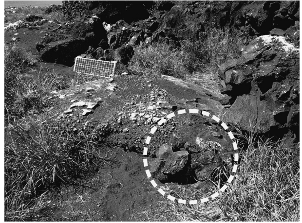
図 13. ソーラーパネルと空振計. 左奥にソーラーパネルが設置されていて、丸で囲んだ石積みの中に空振計がある。
