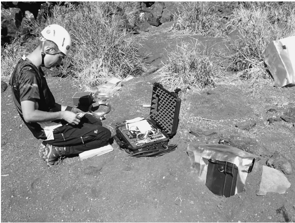
図 12. ボックスの設置. 左で作業中なのがメインボックス、右の半埋設されているのが衛星ボックス。
