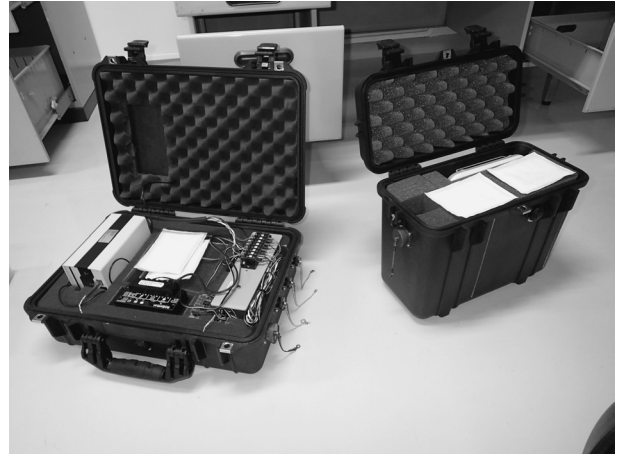
図3. 機器を組み込んだボックス。左)メインボックス。ロガー、バッテリー、ソーラーコントローラ、DC/DCコンバータ、端子台、GPSアンテナが入る。右)衛星ボックス。Thuraya IP+ 端末が入る。
