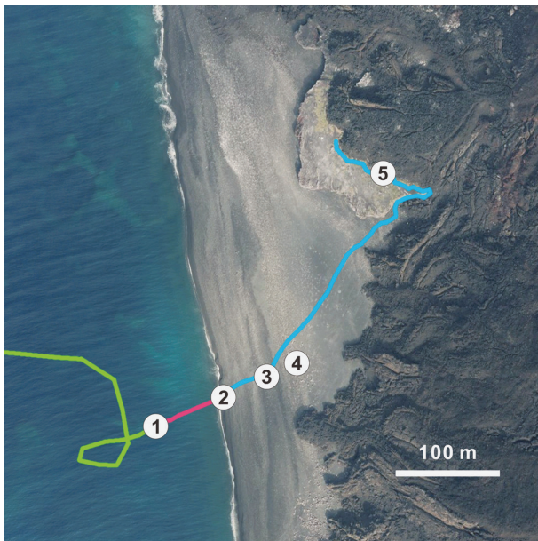
図 10. 国土地理院の鉛直写真にプロットした GPS トラック。緑線はゴムボート、赤線は泳ぎ、青線は徒歩の区間。丸囲みの数字は次の通り。1:浮標, 2:上陸地点, 3:調査・撤収準備地点, 4:荷物残置地点, 5:観測点設置地点。
