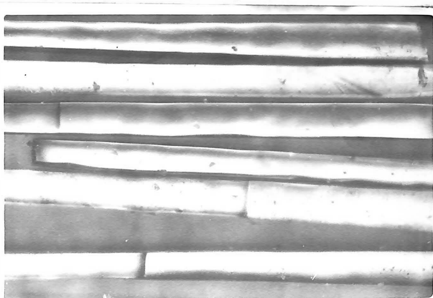
第2.3-4図 エッチ後のバーの写真
