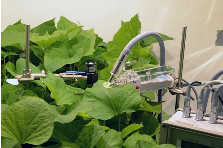
図 2.1: バイオフィードバック機構が備わった LED 照射システムの外観 [1]. 葉の電子伝達速度をリアルタイムで計測し、計測値をもとに LED の照射強度及び照射時間を決定することで LED の消費電力の利用効率が高まる。
