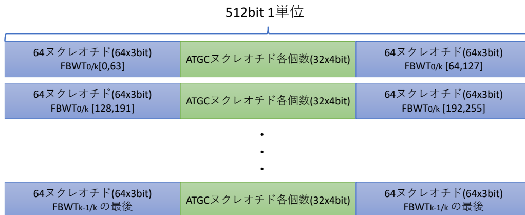
図 10.1: Occ テーブルと FBWT のメモリ配置
