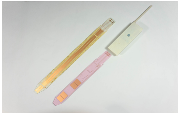
図 3.3: 計測回路と差し替え可能な計測用プローブ
