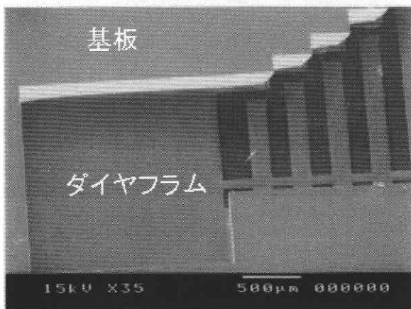
図8 ピエゾ抵抗型周波数分解センサの裏面 SEM 写真
